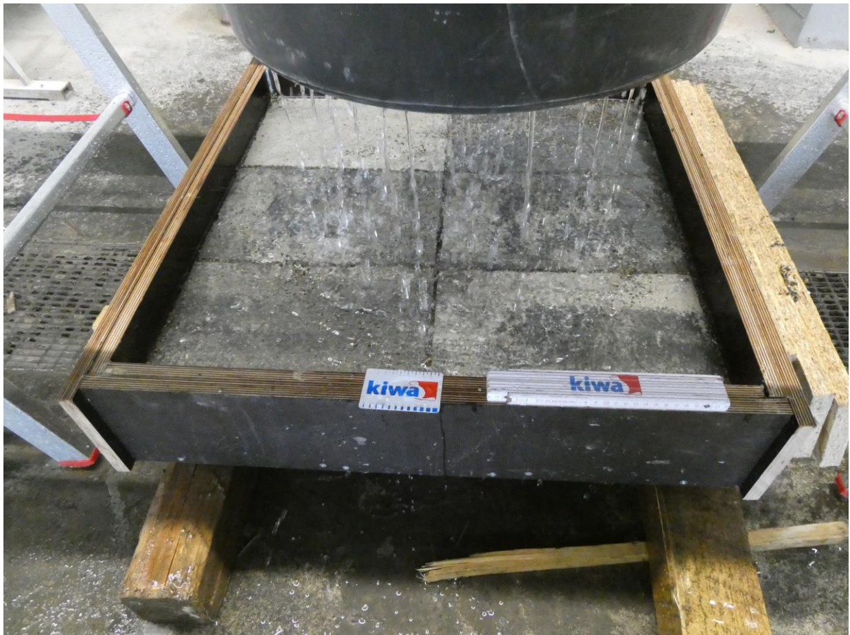
Abbildung 2: Pflastersteine mit Fugenmaterial in der Form verlegt (während der Prüfung)
