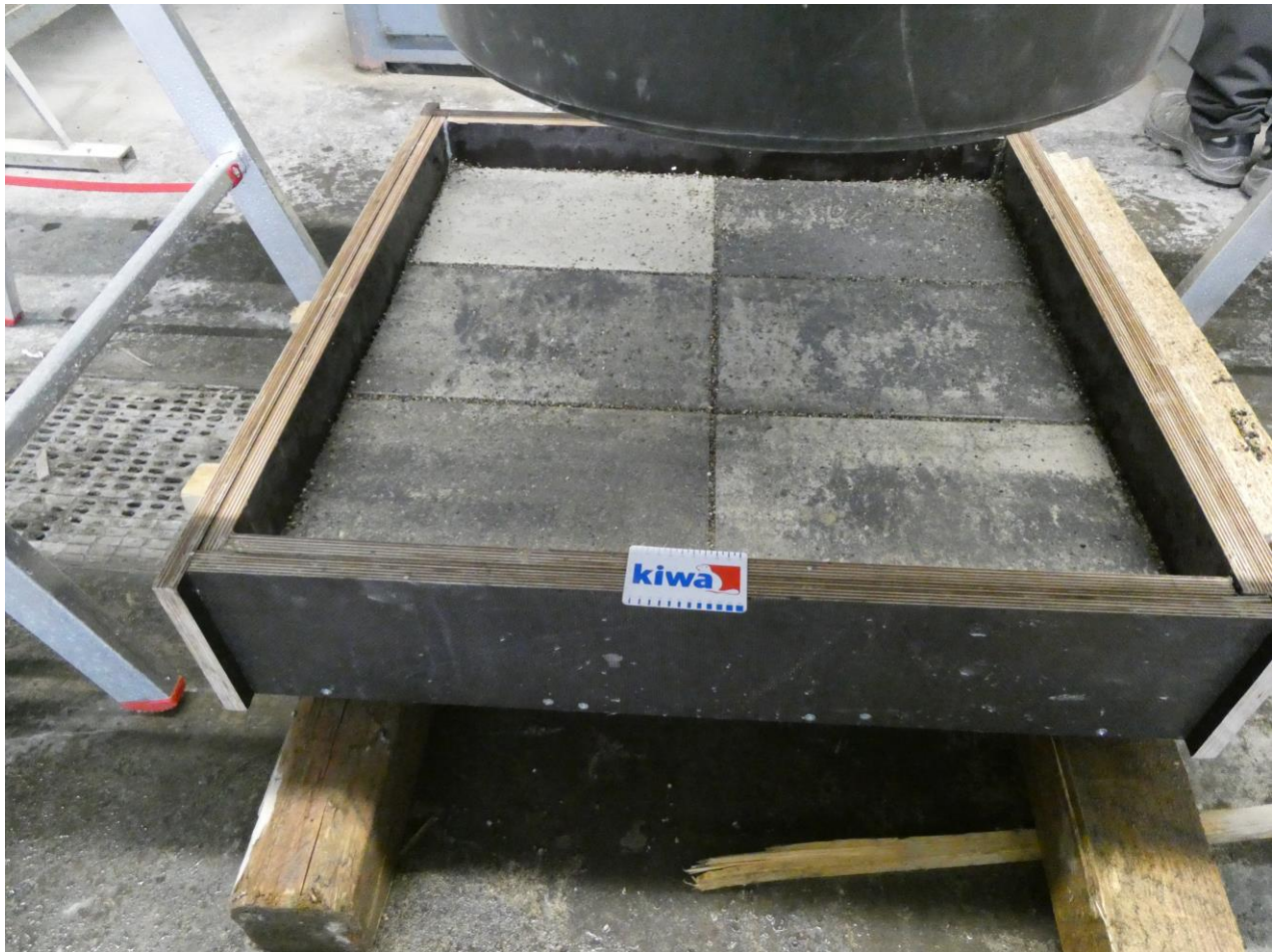
Abbildung 1: Pflastersteine mit Fugenmaterial in der Form verlegt (vor der Prüfung)
