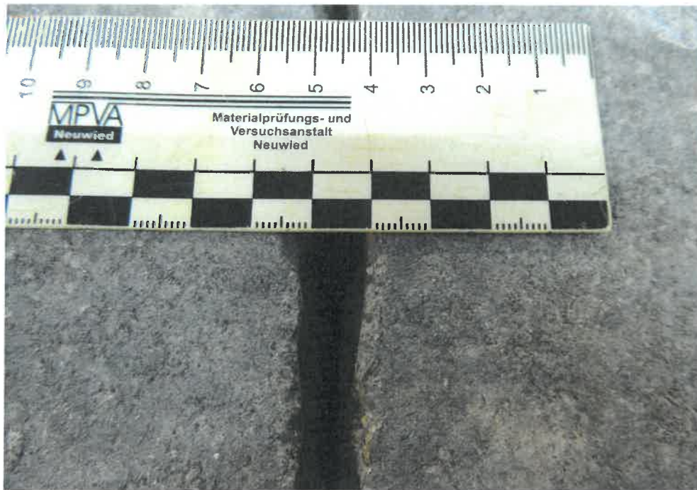
Bild 4: Resultierende Fugenbreite mit Fugenfüllung
