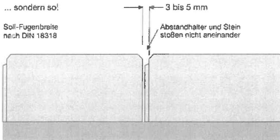
Die Fugenbreiten zwischen den sichtbaren Steinkanten sind in den nachfolgenden Bildern dargestellt.
