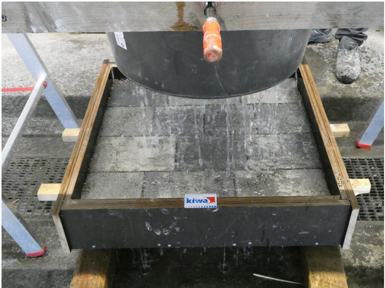
Abbildung 2: Pflastersteine mit Fugenmaterial in der Form verlegt (während der Prüfung) - Symbolbild
