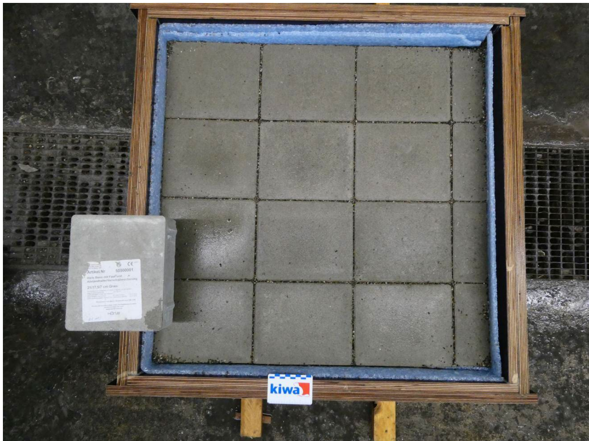
Abbildung 1: Pflastersteine Basic mit Fugenmaterial in der Form verlegt (vor der Prüfung)
