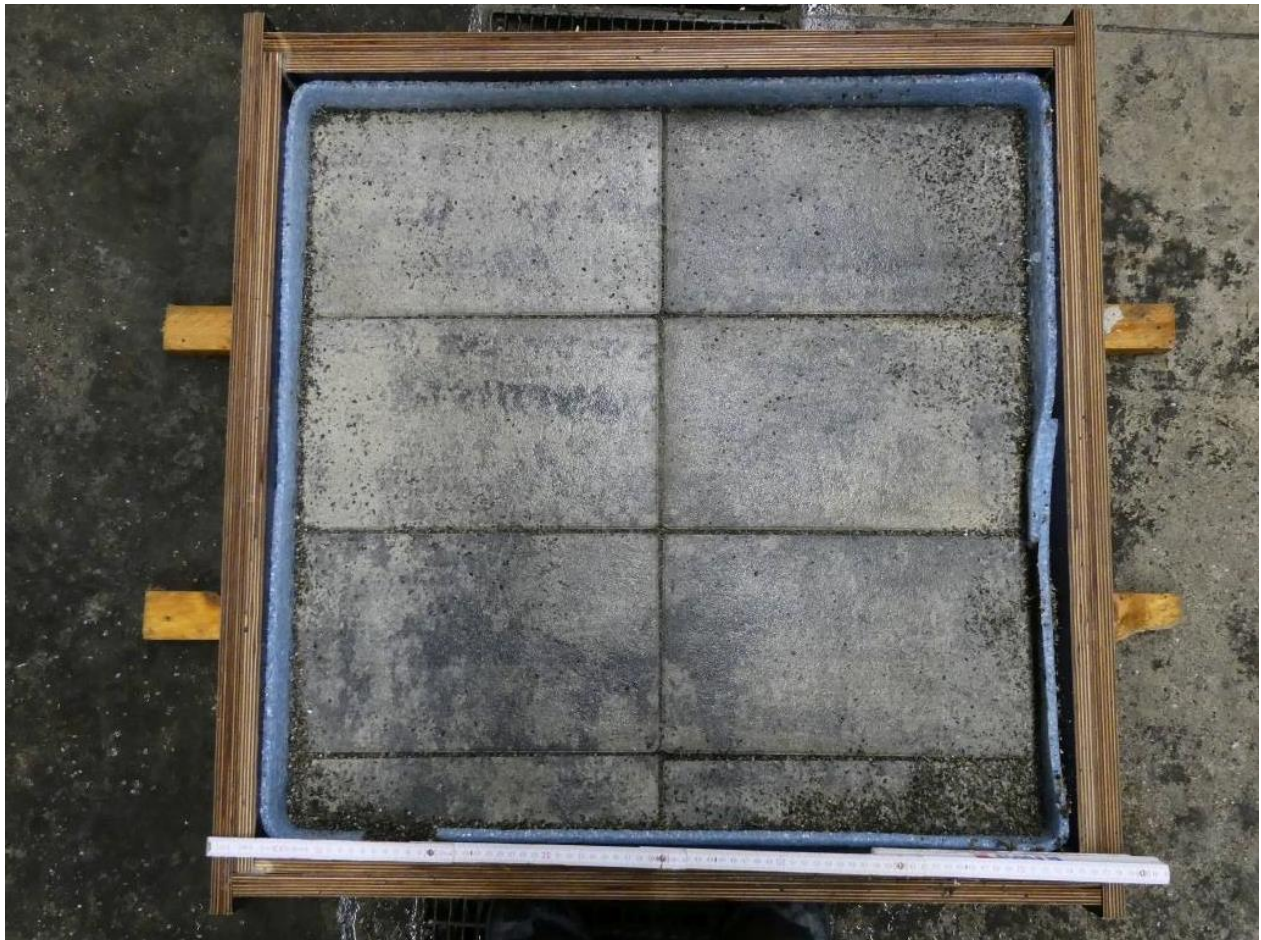
Abbildung 1: Pflastersteine Novalis mit Fugenmaterial in der Form verlegt
